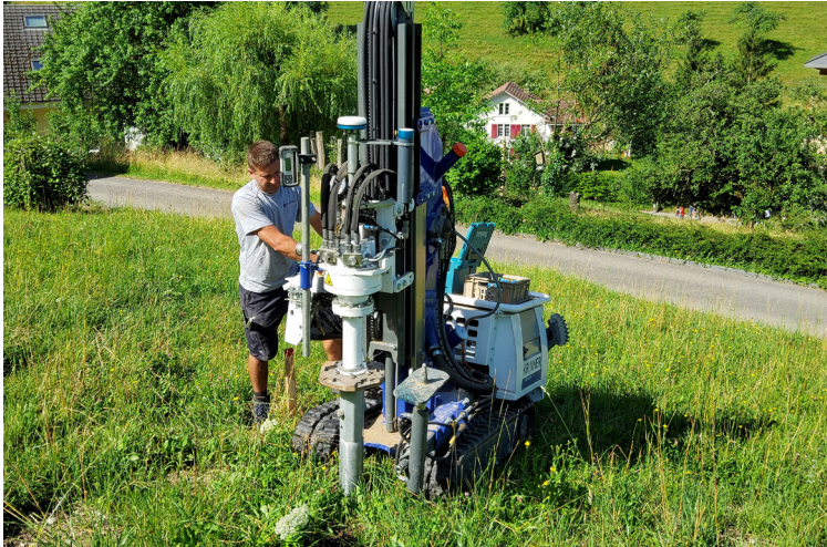
Vorversuche: Eindrehtest mit Drehmomentaufzeichnung
